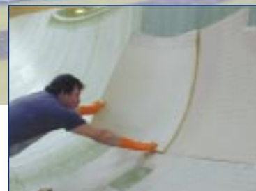
Facilmente montabili nella giusta posizione all'interno dello stampo
